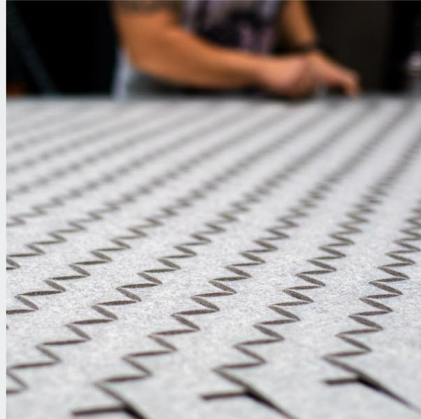
**Produktion.** Jede der eingehenden Bestellungen durchläuft verschiedene Verarbeitungsstationen. Je nach Produkt wird der Filz entweder geschnitten oder gestanzt. Beim Zuschnitt größerer Teile kommt ein computergesteuerter Cutter zum Einsatz, der vorher am Bildschirm konfigurierte Formen schneidet.
