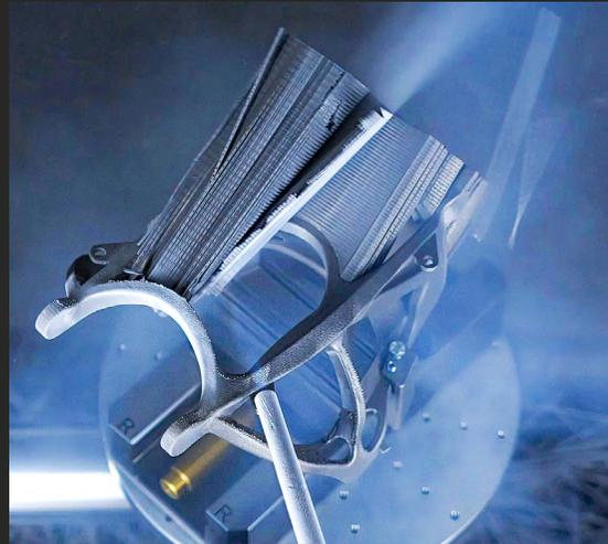
Entfernung der Stützstrukturen
