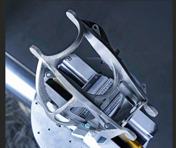
Endzustand des bearbeiteten Bauteils
