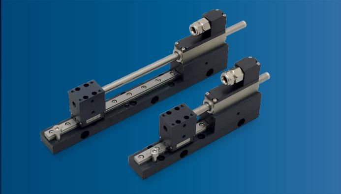
Lineare DC-Servomotoren eröffnen neue Dimensionen für lineare Bewegungen. Diese leistungsstarken und kompakten Linearantriebe bestehen aus einem festen Statorgehäuse mit Spulenpaket und einer vielpoligen Schubstange.
