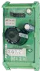
Das **Schaltnetzteil JY** ist ein AC/DC-zu-DC-Multifunktionswandler und bietet die benötigte DC-Stromversorgung. Nützlich als Stromversorgung für Stromschleifen. [Seite 168](#)
