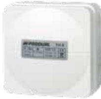
**TH5** kommt als vielseitiges Produkt zum Einsatz wenn die Leistung am Regler-Ausgang für die Last nicht hoch genug ist. TH5 ist ein Treiber in Aufputzmontage, der mehrere parallel verbundene thermische Stellglieder antreiben kann. Das Eingangssignal des Treibers kann ein beliebiges 5...30 V Signal (zeitproportional) sein, das zur thermischen Stellgliedsteuerung verwendet wird. [Seite 167](#)
