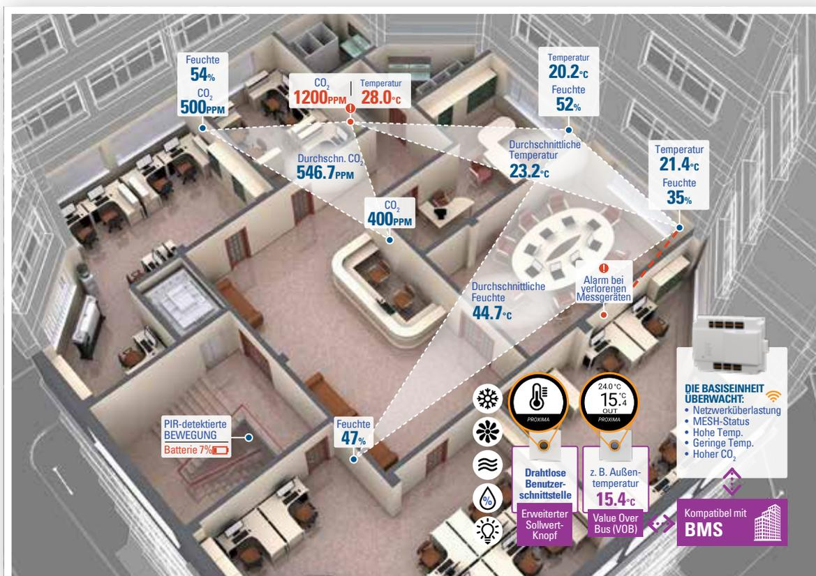
Die Plattform wird mit der weltweit akzeptierten 2,4 GHz-Frequenz betrieben, die in verschiedenen Umgebungen anerkannt wird. Die eindrucksvolle Multifunktionalität bietet zahlreiche Möglichkeiten und Optionen für Systemintegratoren. Die mobile MyTool-App ermöglicht eine einfache Inbetriebnahme, Überwachung und Aktualisierung des Netzwerks. Alle Netzwerkmitteilungen sind auf AES-128-Niveau verschlüsselt.
