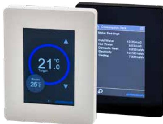
Die Anzeige der Verbrauchsdaten ist eine neue Funktion, die in den -CD-Modellen verfügbar ist. In dieser Ansicht können dem Benutzer beispielsweise Details zum Wasser-, Energie- und Heizverbrauch angezeigt werden. Das BMS-System liest diese Daten von den verschiedenen Sensoren im Gebäude und sendet sie über Modbus oder BACnet an den TRC-A-3A-Regler.
