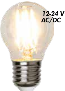
357-71 E-NR 8293449 10/100 45mm 78mm 2700K 80Ra 250lm 2W (≈25W) E27 12-24VAC/DC EC E
