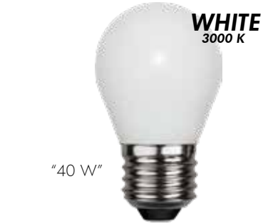
375-24-2 E-NR 8290305 10/100 45mm 78mm 3000K 90Ra 470lm 5W (≈40W) E27 220-240VAC EC F
