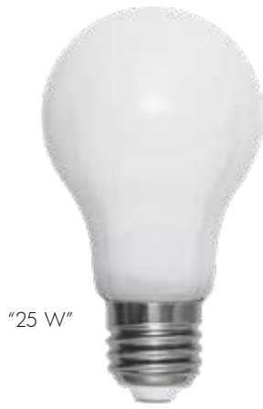
375-28 E-NR 8294309 10/100 60mm 109mm 2700K 90Ra 250lm 3W (≈25W) E27 220-240VAC EC G
