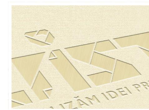
La technique de gaufrage suppose l'application d'une pression sur la partie frontale du papier, en forçant le matériel vers le bas par rapport à la surface du papier. Par rapport à l'embossage, qui crée l'impression de levage du matériel, le gaufrage crée l'impression de profondeur.
