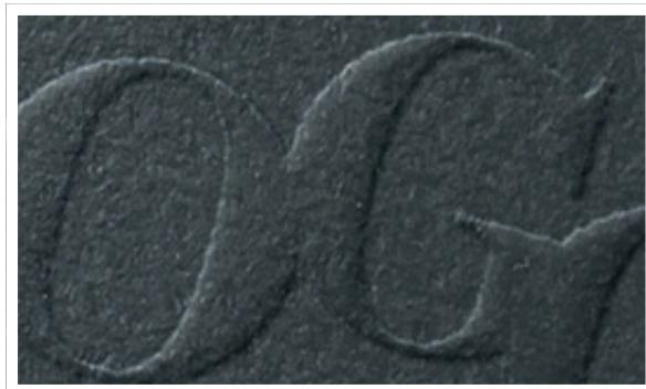
Die Prägetechnik bedeutet das Ausüben von Druck auf der Rückseite des Papiers, um die Oberfläche zu verändern und ihr somit einen dreidimensionalen zu verleihen.
