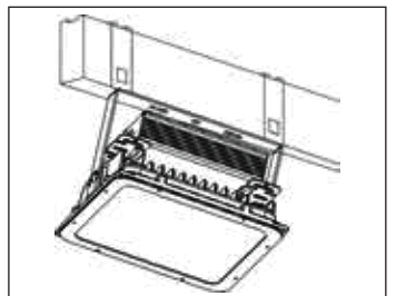
Busbar Bağlantısı Busbar Mounted
