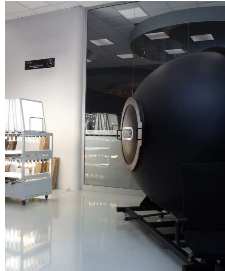
LED line LAB – integrierende Kugel für Lichtmessungen
