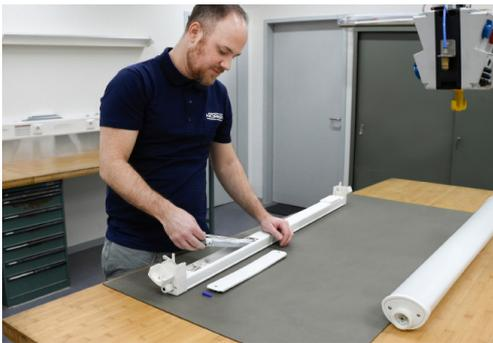
03 Bei Leuchtenfamilien mit „easy eXchange DRIVER“ lässt sich das Betriebsgerät einfach und schnell wechseln.
