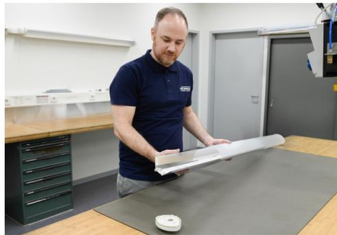
04 Bei den Familien mit „easy eXchange LED“ wie beispielsweise der ERFURT LED können die im Schutzrohr liegenden LEDs gewechselt werden. Das Schutzrohr wird weiter genutzt.
