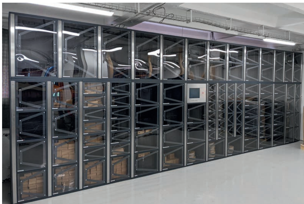
System mit Sonderhöhe bis zu 250 cm für Verwaltung der Rohprodukte und der produzierten Halbfabrikate
