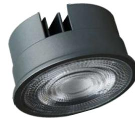
Die KOIN LED-Module sind ein professioneller Ersatz für PAR16/MR16 Leuchtmittel in Deckeneinbauringen. Nur 25mm Einbautiefe durch separaten Treiber! Lichtstarke, dimmbare LED-Module mit 50.000 Stunden Lebensdauer und 5 Jahren Garantie. Einzeln oder im Set mit MEGATRON DECOCLIC Einbauringen erhältlich.
