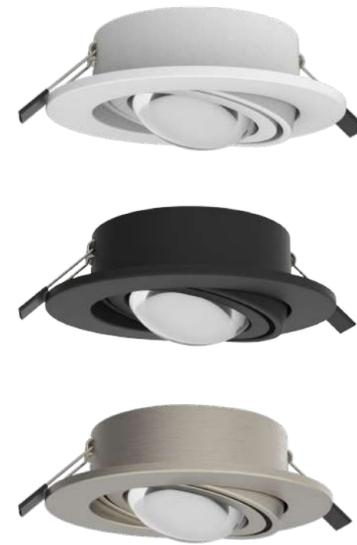
Schwenkbares Spotlight mit 60° Abstrahlwinkel zum Deckeneinbau für 100mm Ausschnitte. Inklusive servicefreundlichem, wechselbarem POWERLENS GX53-Leuchtmittel. Flaches Design mit einer Einbautiefe von nur 43mm.
