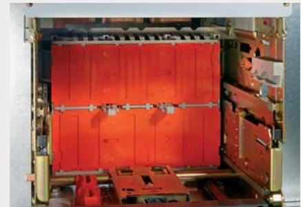
Die Steckkontakte des Einschubchassis werden bei ausgefahrenem Leistungsschalter durch einen Shutter berührungssicher verschlossen.
