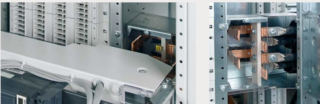
Der Kabelanschluss erfolgt platzsparend hinter dem Steckmodul. Die Klemmstellen sind nach Ausbau des Steckmoduls erreichbar. Ausführung in Form 4b. Optional nach Abstimmung
