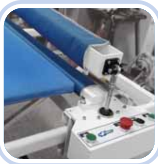
Dispositivo pneumatico regolabile per la messa in misura dei tendaggi. Adjustable pneumatic device for measuring curtains.
