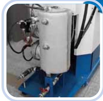
Caldia coibentata da 7 litri con pompa carico automatico inclusa nel tavolo. 7-liter boiler with automatic loading pump included in the table.
