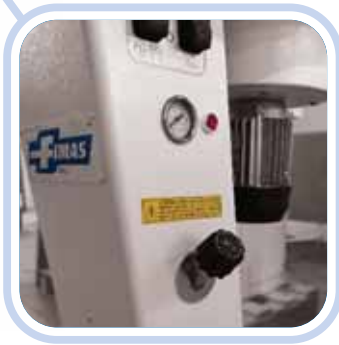
Caldaia incorporata da 5 LT, con carico manuale. 5 lt built-in boiler with manual loading.
