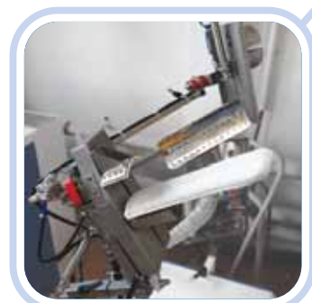
Pinze con chiusura ed espansione dei polsi/maniche corte, con automatismo per tensionamento e regolazione tendi manica. Adjustable and tensioning clamps with automatic closure of cuffs and sleeve.
