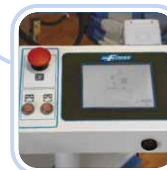
Programmatore dotato di Touch Screen 7" con 20 programmi memorizzati e possibilità di impostare varie lingue. Mobile programmer equipped with a 7" touch screen with the possibility to set up 20 memorized programs and the possibility to set various languages.
