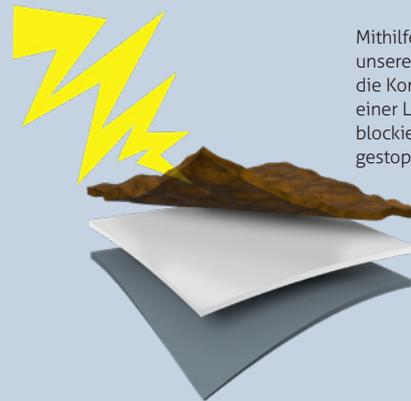
Mithilfe der Technologie in unserem GXE-Material wird die Konvektionshitze während einer Lichtbogen-Exposition blockiert und die Ausbreitung gestoppt.
