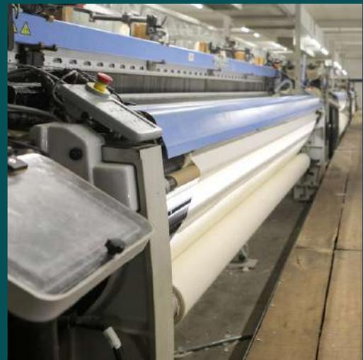
Mit einer internen Kapazität von 25.000 Metern Servietten und Laken pro Tag werden unsere Webereien von 36 elektronischen Schaftgreiferwebmaschinen von ITEMA angetrieben. Dies gewährleistet eine effiziente Produktion und höchste Qualität für unseren Hotelwäschesektor.
