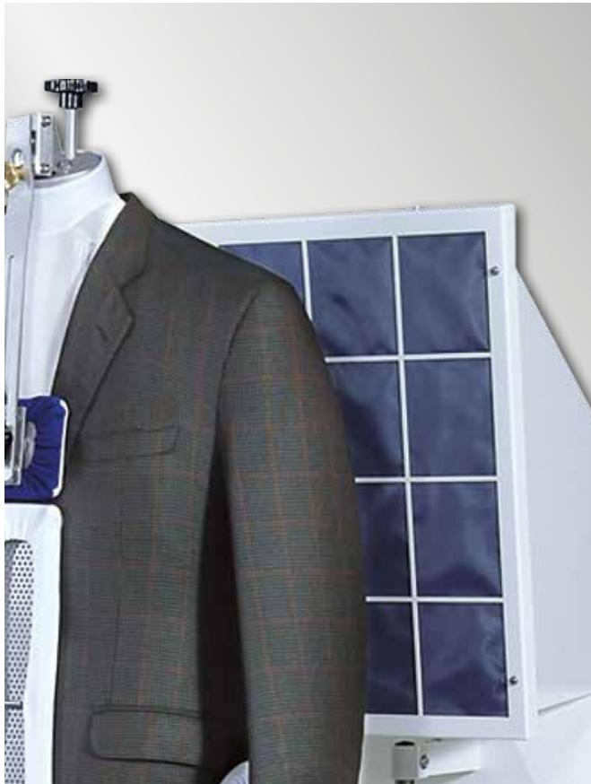
**IT** Il manichino mod. 453, oltre tutte le caratteristiche del mod.451, possiede il dispositivo di **ricircolo calore** integrato, che consente ad ogni ciclo di abbassare i consumi recuperando il calore e contemporaneamente mantenendo la qualità dell'aria dell'ambiente di lavoro.
