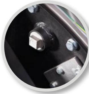
BÖWE bildet eine sehr glatte Oberfläche durch eine spezielle Kataphorese-Beschichtung durch galvanische Ionenanlagerung. So werden Lagerflansch, Trommelgehäuse rückwand, Kältereister, Lüftergehäuse, Nadelfängerkorb etc. vor Flusen geschützt. Das Resultat sind geringere Chargenzeiten, Energie- und Lösemittelverbräuche.
