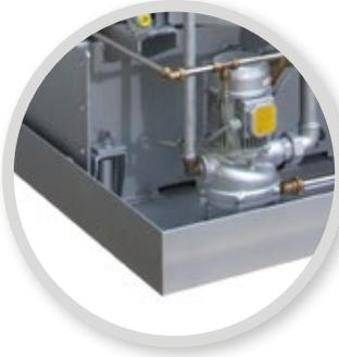
Eine integrierte Lösemittelsicherheitswanne mit Unterlegschienen zum Unterleuchten der Wanne bei Inspektionen ist Standard in jeder BÖWE Maschine, unabhängig davon in welchem Teil der Welt die Maschine aufgestellt wird.
