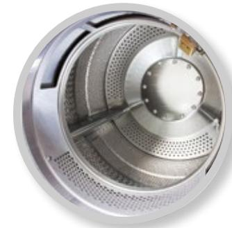
Die von BÖWE patentierte dynamische Trommellochung mit weniger Löchern im vorderen Bereich der Trommel und mehr Löchern im hinteren Bereich sowie der Trommelrückwand zwingt die Luft axial durch die zu trocknenden Textilien. Diese effiziente Trocknung ist besonders geeignet für Problemzonen wie Schulterpolster. Eine Eigenschaft, die nur BÖWE PremiumLine Maschinen bieten.
