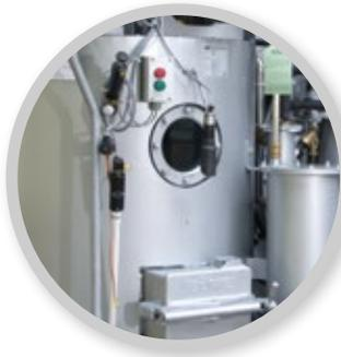
Runde Formen ohne Ecken und Kanten an der Heizoberfläche erlauben ein gutes Abpumpen von Destillationsschlamm. In Verbindung mit der Destillationsspülung durch Umpumpen wird der Destillationsboden sauber gehalten und der Schlamm kann sich nicht einbrennen.
