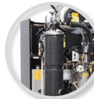
Kompakt – sogar mit zusätzlichen Sonderausstattungen um die aktuellen Umweltauflagen einzuhalten wie emissionsfreie Destillationsentsorgung und integrierte Aktivkohleanlage SlimSorba, um geruchsfreie Textilien und eine extrem niedrige Lösemittelkonzentration zu erreichen werden die Grundmaße der Maschine nicht überschritten. Die Desorption kann durch vollautomatische Wartungsprogramme gestartet werden.
