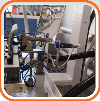
Bloccaggio del fondo capo tramite fotocellula per un corretto tensionamento. Locking of the bottom of the garment by photocell for proper tensioning.
