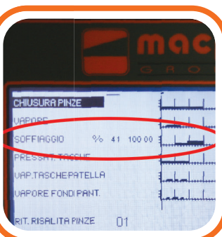
Regolazione quantità soffiaggio con inverter Regulatable blowing power with in- verter
