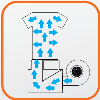
Stabilizzazione tessuto con aria fredda. Fabric stabilization with cold air.
