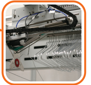
Carico gruccia in automatico. Automatic hanger loading .
