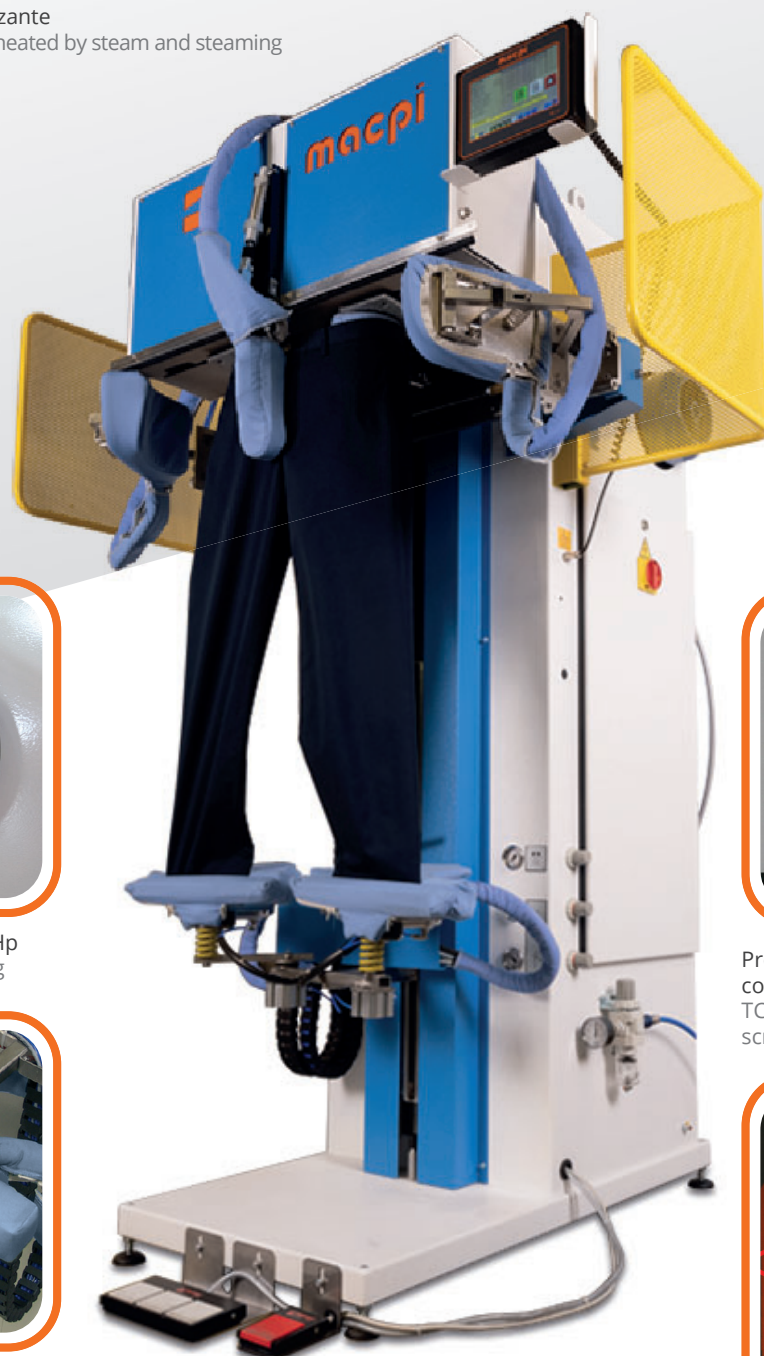
Stabilizzazione tessuto con aria fredda. Fabric stabilization with cold air. (vers.25-28)
