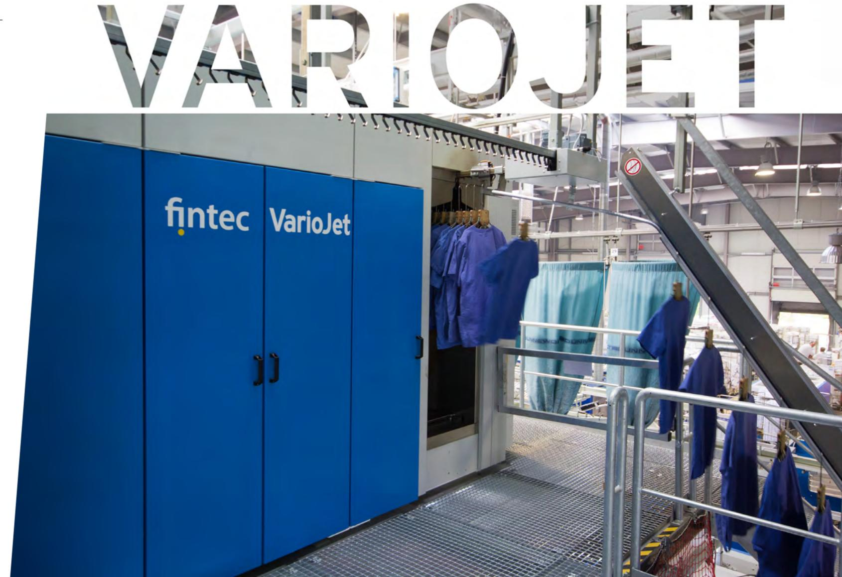
und 506 mit Stundenleistungen von 200 bis zu 2.000 Teilen lieferbar. Alle FTS Modelle sind in U oder in L Form, alle FT Modelle hingegen mit geradem Durchlauf erhältlich. Sämtliche VarioJet Modelle können wahlweise mit Schnecke oder Kettenantrieb ausgestattet werden.
