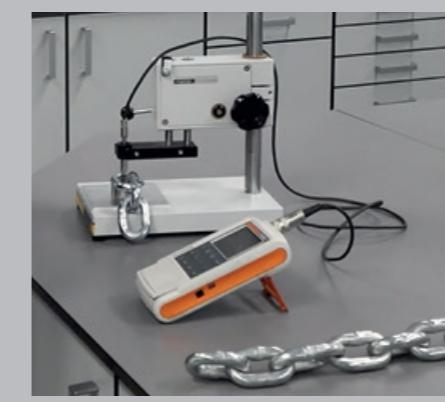
Le catene conveyor devono avere ottime caratteristiche di protezione superficiale al fine di evitare il rilascio di eventuali elementi contaminanti. Per le catene MF è previsto, ove richiesto, un doppio trattamento di zincatura elettrolitica con spessori sino a 25 micron.
