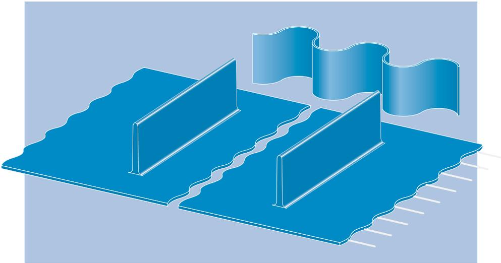
Profile können in engen Toleranzen auf die Bänder aufgeschweißt werden. Individuelle Profilhöhen sind möglich. Bei formschlüssig angetriebenen Bändern befindet sich die Schweißposition mittig zwischen den Zähnen.
