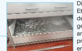
Die abgefrästen Etiketten werden auf dem Lochblech gesammelt, um sie anschließend problemlos zu entnehmen.
