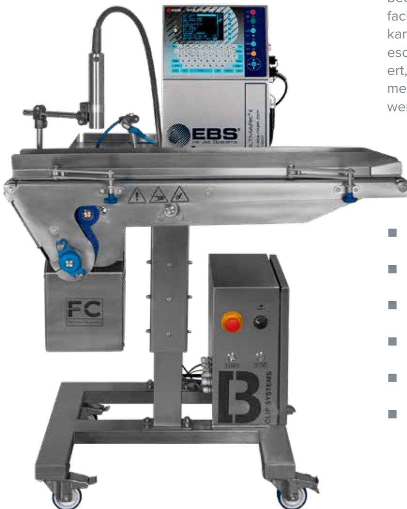
Dieses universelle Gerät für die Lebensmittelindustrie wurde als Endlinienzubehör entwickelt: Produkthüllen bedrucken Sie damit schnell und einfach. Unser BCS Markierungssystem kann direkt an einen Clipper angeschlossen werden. Separat installiert, können verschiedene Hüllen aus mehreren Produktionslinien bedruckt werden.
