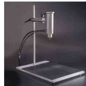
Standardhaltevorrichtung - Der Prüfkopf kann mit einer scharfen oder flachen Nadel oder einem Tubenadapter kombiniert werden
