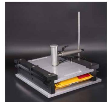
Ausdehnungsbegrenzung gemäß ASTM F2054 - hält die Packung flach, um sicherzustellen, dass der Druck auf alle Siegelnähte gleichmäßig wirkt
