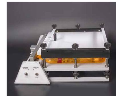
Pneumatische Packungsklemme (PPC 300 II) - Durchführung von Berstprüfungen für Verpackungen oder Beutel, die auf einer Seite offen sind
