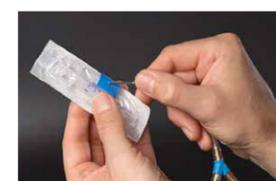
Ein Septum sorgt für einen luftdichten Verschluss und schützt die Verpackung vor dem Aufreißen. Verschiedene Septentypen eignen sich für verschiedene Verpackungen und Nadeln.
