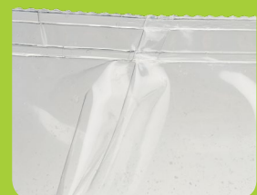
Falten in der Siegelnaht
