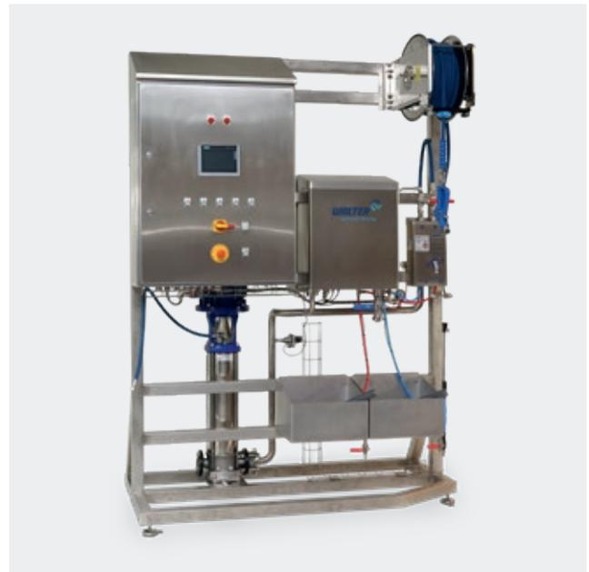
Modulare Fülleraußenreinigung für bis zu 14 Zonen
