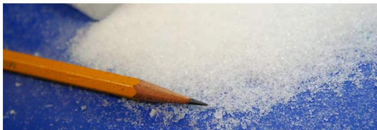
Der i<sup>3</sup> MicroClean 2 schabt Trockeneis in Mikropartikel (zuckergroße Trockeneispartikel). Die Trockeneis-MicroParticle-Technologie von Cold Jet bietet eine gründliche, aber dennoch schonende Reinigung für viele Anwendungen.
