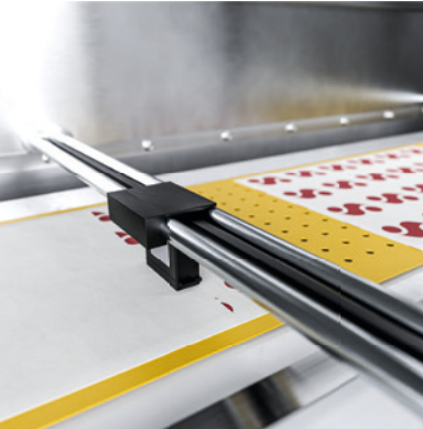
Vakuumzahnriemen für den Transport von Papier
