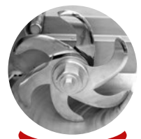
Tête avec 6 couteaux Head with 6 knives
