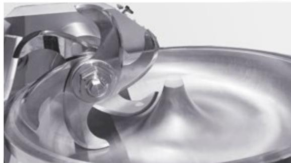
fältig und präzise aufeinander abgestimmt. Die dickwandige, aus hochwertigem Edelstahl gegossene Cutterschüssel verfügt über einen extrem genauen Rundlauf, was ein enges Einstellen der Cuttermesser im Schüsselradius ermöglicht. Die Lagertechnik der Messerwelle erlaubt einen dauerhaften Einsatz auch bei hoher Drehzahl.
