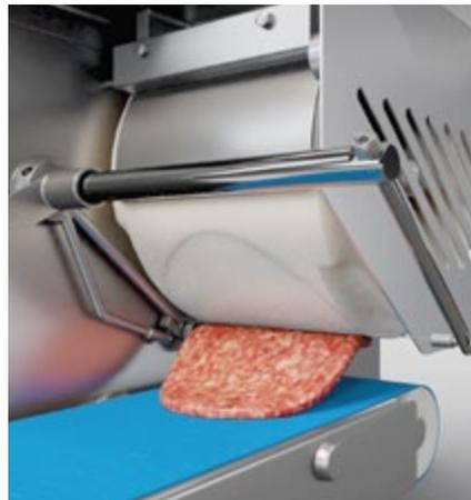
Die zu formende Masse wird in den Einfülltrichter gefüllt und der rotierende Mengarm drückt die Maße schonend in die Formwalze. Die Stärke der Pattys – und somit das Gewicht – kann in der Formwalze stufenlos eingestellt werden von 5–25 mm. Sondergrößen sind lieferbar.
