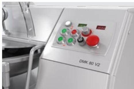
Die klare Anordnung des Bedienfeldes mit Drucktastern und Drehpotenziometer zur stufenlosen Einstellung der Drehzahlen gewährleisten ein bedienfreundliches Arbeiten. Das Anwendungsgebiet wird durch den zusätzlich getrennt schaltbaren Schüssel-Motor mit zwei Geschwindigkeiten erweitert. Die als Option erhältliche Auswerfeinheit ermöglicht ein optimales und müheloses Entleeren der gefüllten Cutterschüssel.
