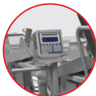
**Терминал с дисплеем для отображения параметров рецепта**
