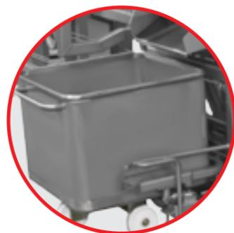
**Электро-гидравлическое опрокидывающее устройство для дозировки точного количества каждого ингредиента в смесь**
