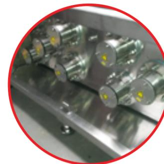
**Дополнительный электрический нагреватель** в потоке (если вода для ополаскивания слишком холодная)
