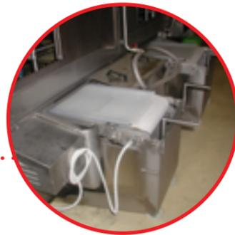
**Сетчатая конвейерная лента**
