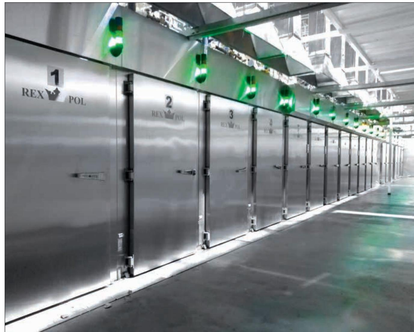
Основными источниками нагрева камеры являются: электрическая энергия, технологический пар, газ или мазут. В стандартной комплектации коптильно-варочные камеры оснащены следующими составляющими: высококачественный микропроцессорный контроллер, который обеспечивает автоматический контроль всех параметров технологических процессов, двухступенчатая система циркуляции воздуха в камере, автоматическая система мойки камеры, герметичный „колосниковый“ дымогенератор, работающий на коптильной щепе.
