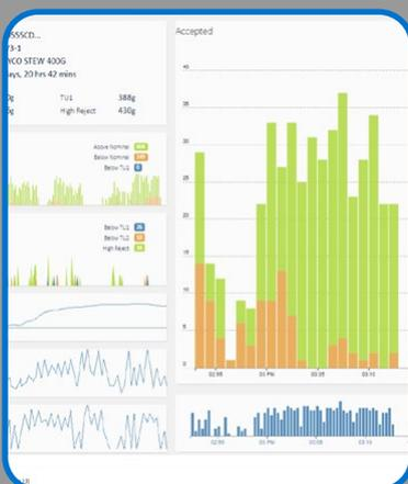
LOMA TRACS ist eine Softwareanwendung, die eine zentralisierte Echtzeit-Datenverwaltung ermöglicht. Hierfür ist ein LOMA Gerät erforderlich, das via Ethernet mit einem zentralen Server verbunden ist. Dadurch wird das Reporting von aktuellen und historischen Batch-Informationen, auch über mehrere Maschinen hinweg, ermöglicht.
