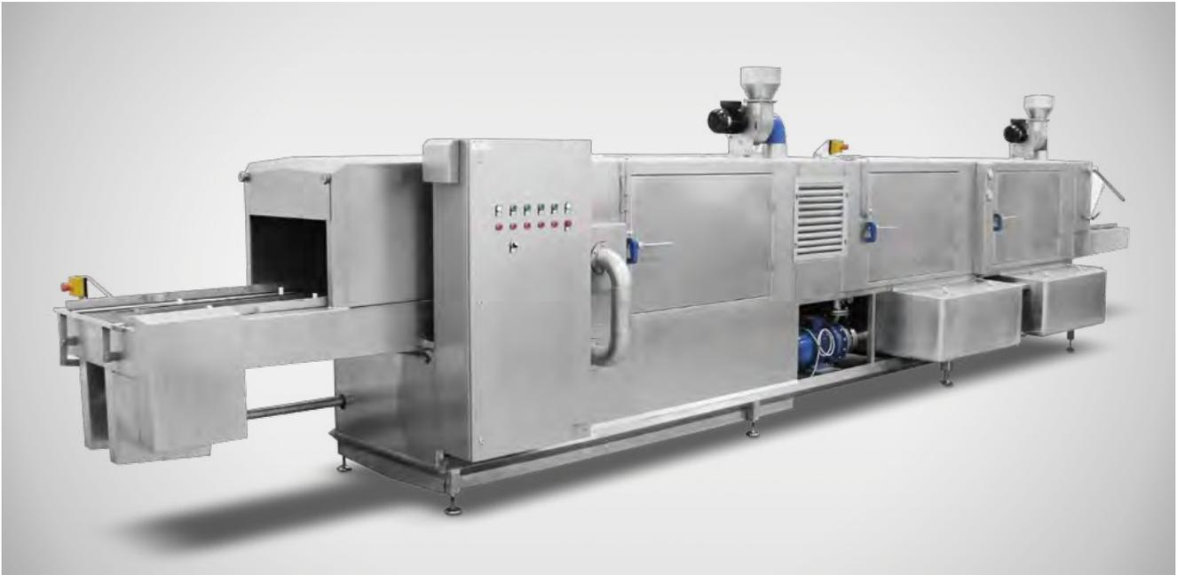
Durchlaufwaschanlage zur Reinigung von Kisten und Paletten mit einer Durchlaufhöhe von 310 mm und einer max. Durchlaufbreite von einmal 820 mm [einspurig] bzw. zweimal 410 mm [zweispurig].
