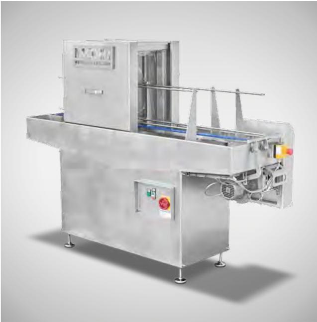
Zur Desinfektion der Messerkörbe im Durchlaufverfahren mittels hochwirksamen Aktivsauerstoff
