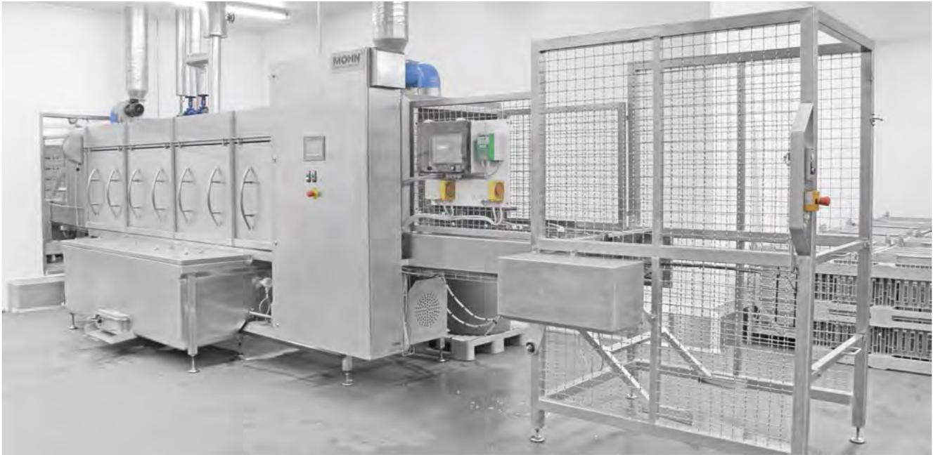
**Zur Reinigung von typisch verschmutzten Hub- und Beschickungswagen Typ 200 ltr; Leistung 30 bis 60 Stück/h je nach Ausführung.**
