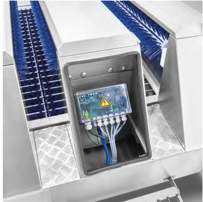
Typ Boot-Star II, Steuerungskasten
