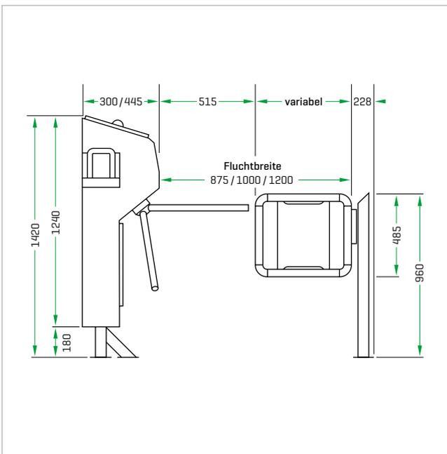
Durch Verbindung der Drop-Arm Drehsperre mit dem Magnet-Flügeltor können so Fluchwege von 875 mm bis 1200 mm, gemäß Arbeitsstätten-Richtlinie [ASR-A 2.3], auch in schmalen Hygienegängen realisiert werden!
