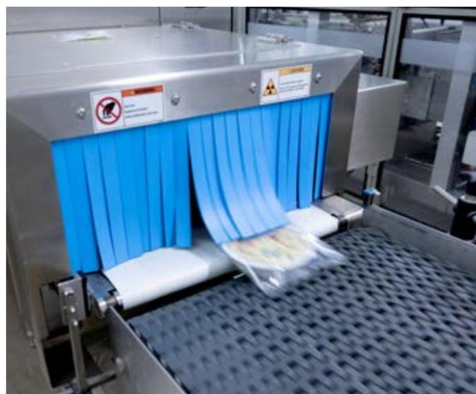
Abb. 1: Tiefgekühlte Quiches werden mit einem Röntgenscanner auf Fremdkörper inspiziert
