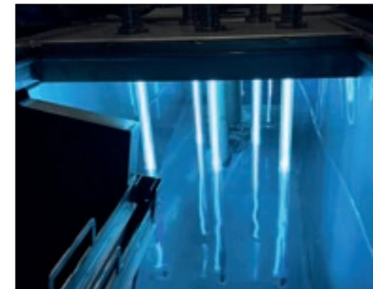
*sterilAir® AQT zur Wasserentkeimung in einem CIP-Tank und einem Luftwäscher.*
