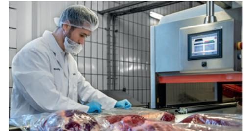
Ein-Mann-Bedienung mittels optimierter Bandformate bzw. Taktband.
