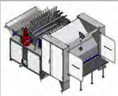
**RENNER-BRÜH-UND ENTHAARUNGSMASCHINEN** sind für Leistungen bis 200 Schweine pro Stunde entwickelt worden. Je nach Gewicht der Schweine werden 1 oder 2 Tierkörper in der schweren **RENNER-BRÜH-UND ENT-HAARUNGSMASCHINE** bearbeitet.
