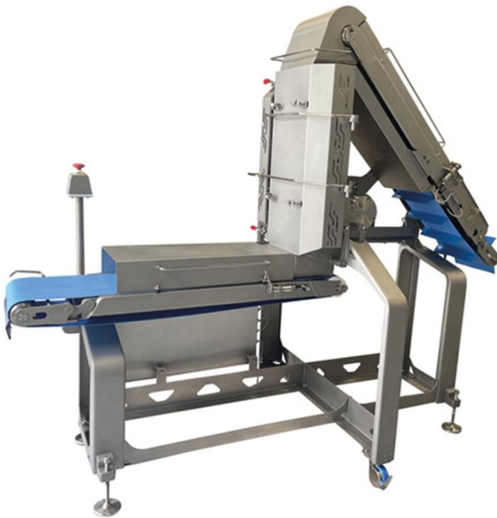
Hochleistungs Fleisch Shredder mit kontinuierlichem Durchlauf für Pulled Pork, Geflügel und Rind, mit einer Textur „wie von Hand gemacht“ – kein Schneiden oder Quetschen der Fleischfasern, einheitlich gleichmäßig geshreddertes Fleisch mit geringstem Ausschuss.
