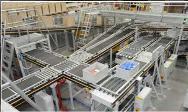
Kunststoffbehälter werden mit motorgetriebenen Rollen gefördert und überführt
