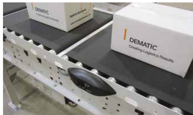
Elektronische Sensoren im Schutzgehäuse
