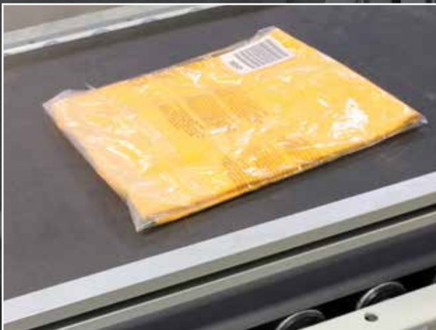
Gurtsegmente mit Rollenmotoren transportieren auch Versandtaschen
