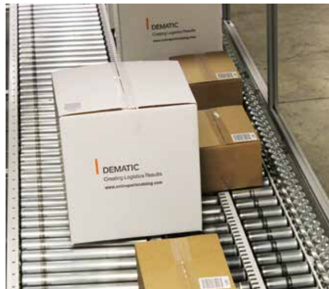
Der Vereinzeler verbessert die nachgelagerte Zusammenführung und Sortier-Leistung
