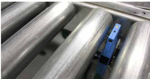
Stauförderer mit Näherungssensor
