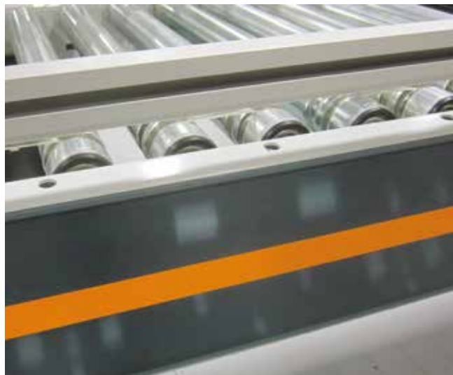
Seitenwange mit optionaler Wangenverkleidung
