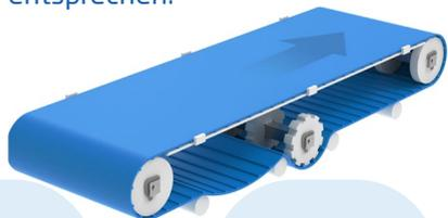
Ein formschlüssig angetriebenes Band wird von Kettenrädern angetrieben, die in eine Zahnstruktur unterhalb des Bandes eingreifen.
