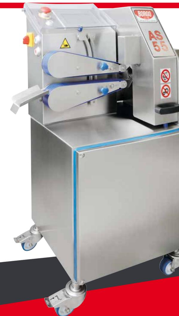
La qualità è aumentata grazie al **nuovo sistema di chiusura delle pinze**, con nuove valvole pneumatiche e nuovi motori con tecnologia servo-drive, abbinati ad un **controllo remoto via Ethernet**.
