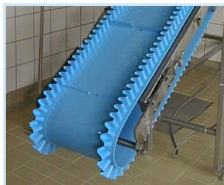
SuperDrive™ mit Wellenkanten und Spezialstollen
