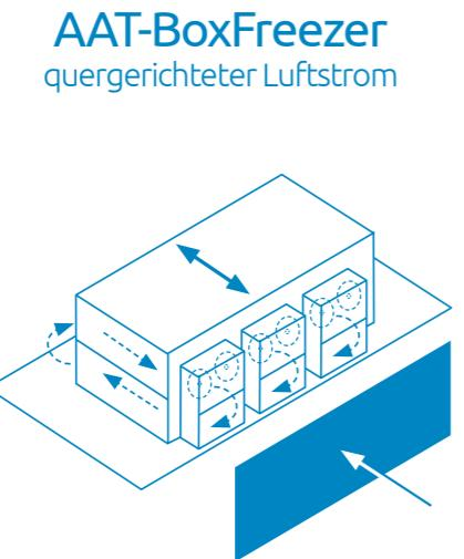
Mit einem quer gerichteten Luftstrom ist die zurückgelegte Distanz wesentlich kürzer – um knapp 10 Meter – und deckt einen wesentlich größeren Bereich ab. Dadurch werden alle Kartons mit einem konstanten Luftstrom gekühlt.
