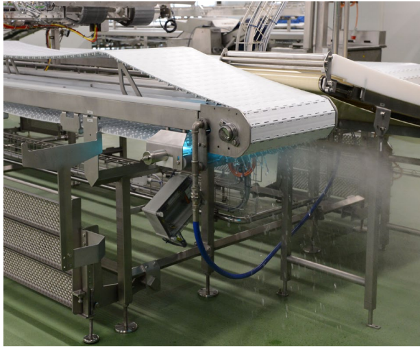
steriBELT Modul während der Reinigung
