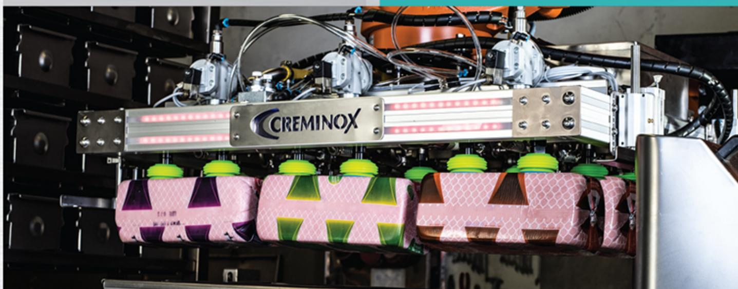
Desmoldador por línea de jamones mediante ventosas y el efecto del vacío producido por una bomba, con retención simultaneo del Molde apoyado sobre la mesa. En el caso del desmoldado del nivel completo de Moldes, actuará sobre los mismos una barrera de retención y el griper con la totalidad de ventosas para todos los jamones a retirar de los Moldes.
