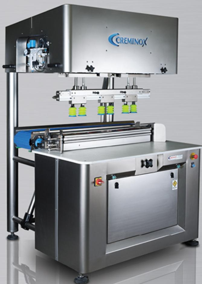
Según el formato o tamaño de piezas a desmoldar, el cabezal portaventosas se puede reemplazar para lograr una ubicación y centrado de las ventosas para cada jamón (Cabezal de 6 u 8 ventosas).
