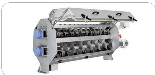
Dank breiter Türen ist der Vorkonditionierer besonders zugänglich und hervorragend zu reinigen.
