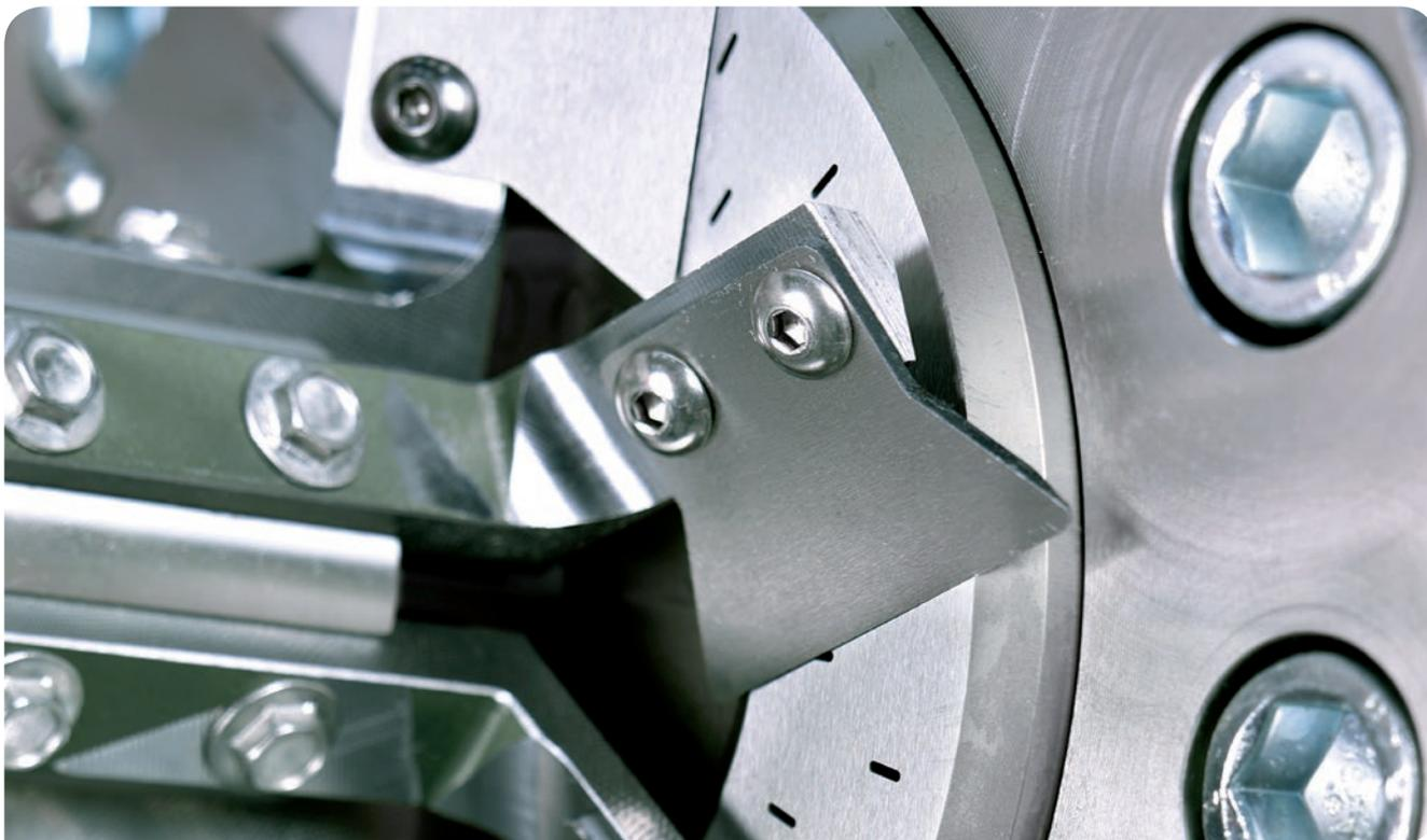
Der Schneideapparat lässt sich seitlich verschieben, dadurch kann der Messerkopf sogar während der Produktion gewechselt werden.
