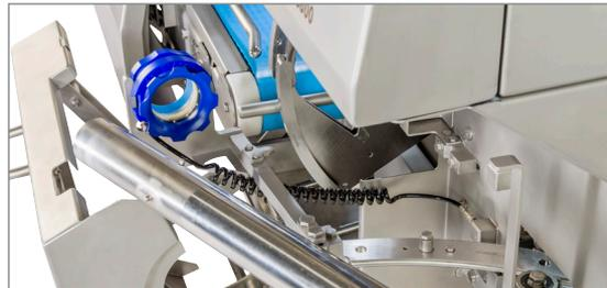
S-förmige Darmbremse für einen schnellen Darmwechsel
