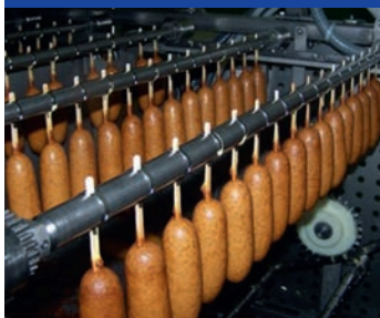
Corndog Automation für bis zu 16.000 Corndogs pro Stunde.
